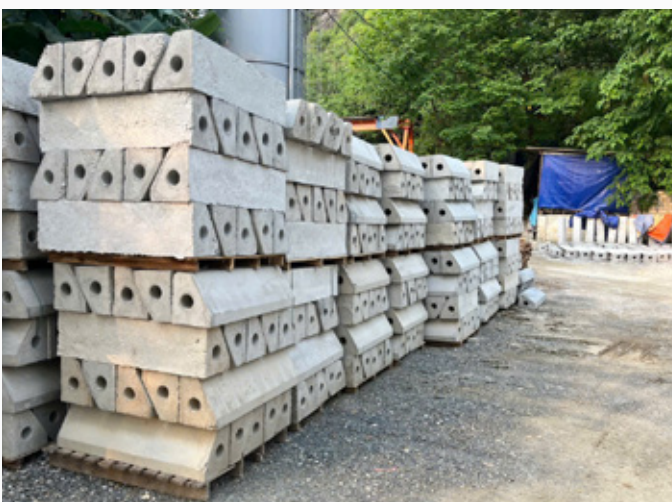
BÓ VĨA BÊ TÔNG
